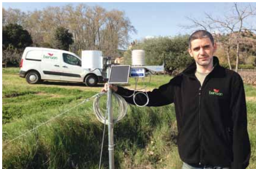
BAPTISTE PEÏDRO , agent technico-commercial du négociant de produits phytos Bergon, assure que la station couvre dix kilomètres à la ronde. Elle enregistre plusieurs données météo. Ensuite, ces mesures sont traduites en risques mildiou et oïdium.
