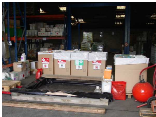
Aire de réception avec étanchéité, extincteur, carton 4GV sur palette, point d'eau
